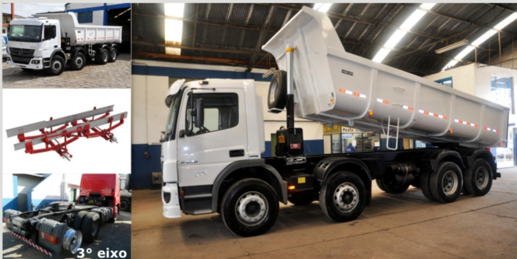
O segundo eixo MM/Quatro M proporciona aumento de até 6 ton, 26% a mais no PBT, na transformação do veículo original de 6x2 e 6x4 para a configuração 8x2 e 8x4, assim propiciando um aumento médio de 5 ton. Ou seja, até 45% a mais na carga líquida por viagem. Isto resulta num ganho de 1 carga para cada 2 a 2,5 viagens realizadas, o que significa um retorno sobre o investimento em curto prazo. Fonte: MM
